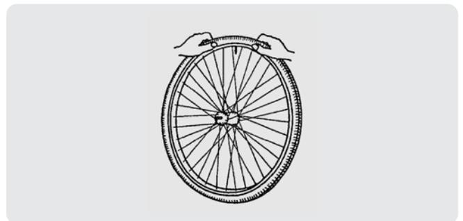
Liegt der Schlauch rundherum faltenlos im Reifen (wirft er Falten, etwas Luft ablassen), dann lässt sich die obere Reifenseite gegenüber dem Ventil beginnend, leicht mit beiden Händen aufs Ventil hinmontieren.
